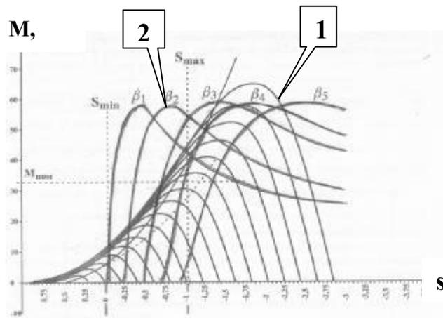
**Рис.5. Механические характеристики ВТ и ЭГ в координатах  $M = f(s)$**
