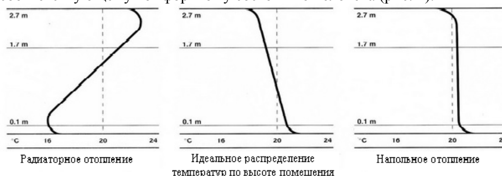
Рис.1. Распределение температуры по высоте помещения для различных видов отопления
