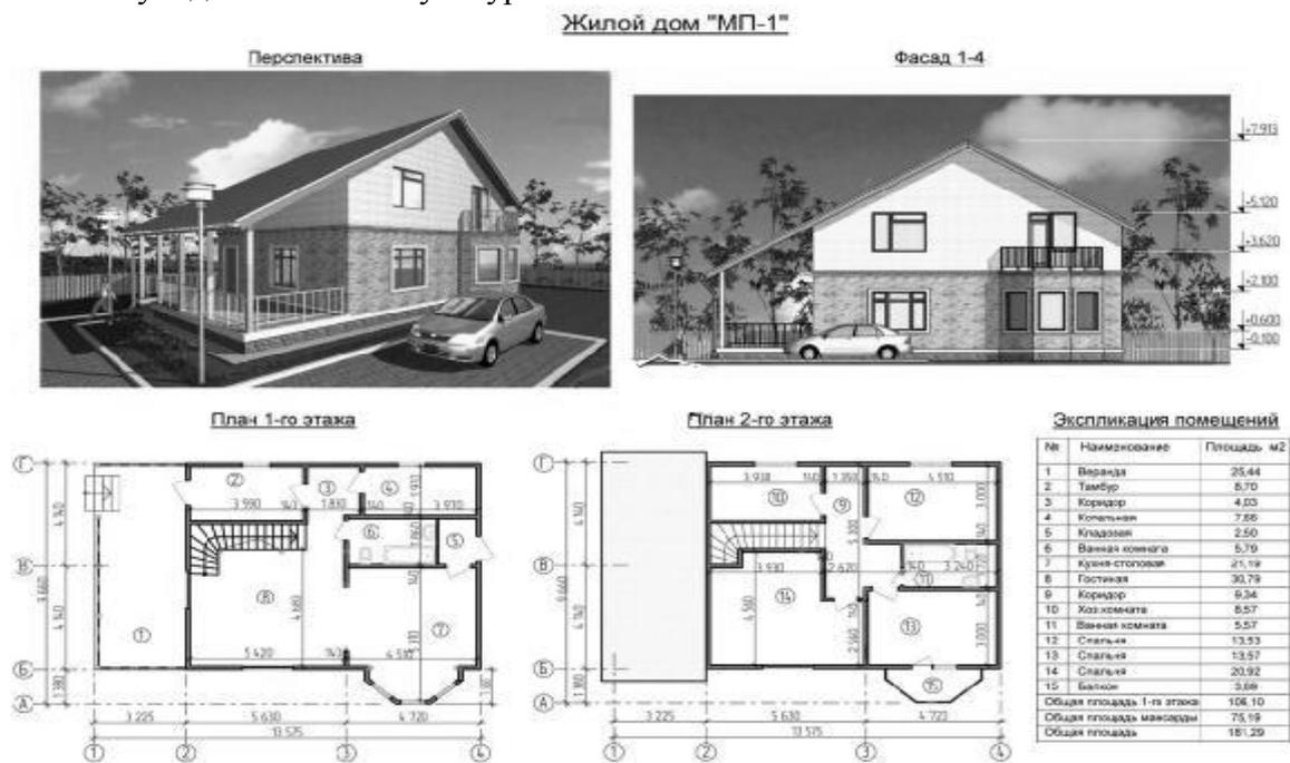
**Рис. 1. Планы и фасады жилого здания**
