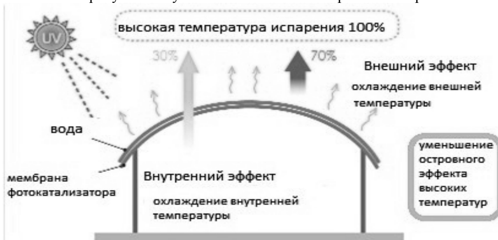
Рис. 4. Система охлаждения мембраны Фотокатализатора
