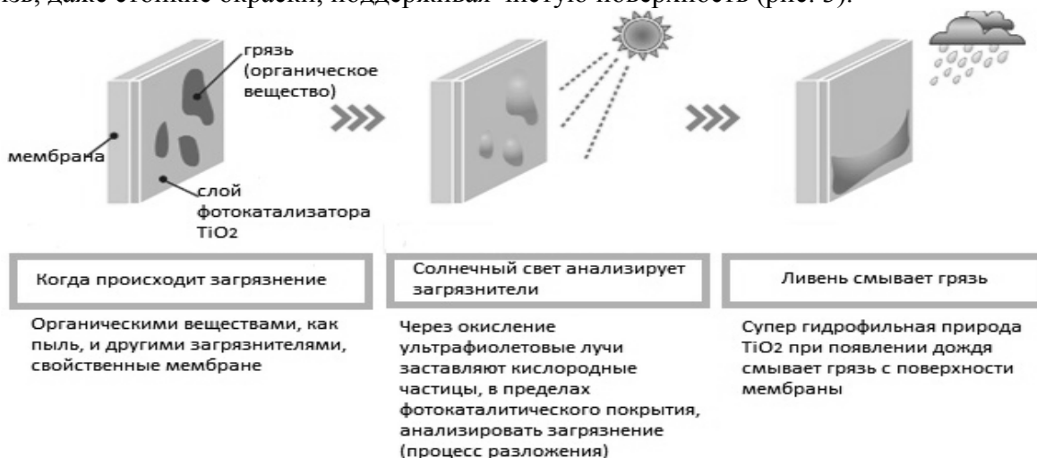
Рис. 3. Механизм фотокаталитического процесса (SCC и SMX)
