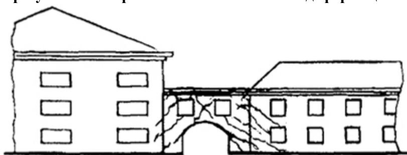
Рис. 10. Повреждение перехода между зданиями от горизонтальных деформаций сжатия ВЫВОДЫ
