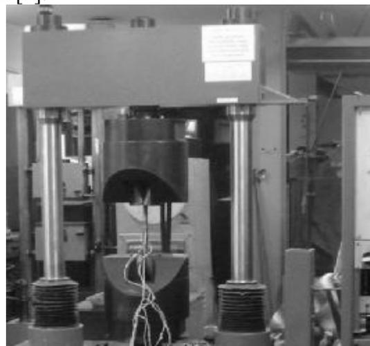
**Рис. 5. Испытания образца в разрывной машине**
