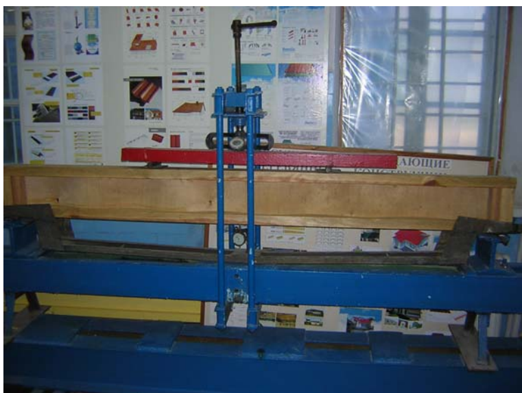
Рис. 7. Клеефанерная балка с волнистой стенкой вклеенной в паз осуществленный в полках из цельной древесины в испытательном стенде.
