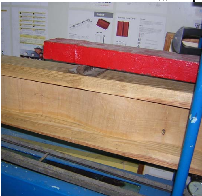
Рис. 8. Клеефанерная балка балка с волнистой стенкой вклеенной в паз осуществленный в полках из цельной древесины в испытательном стенде.
