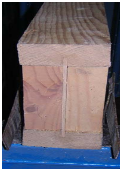
Рис. 7. Клеефанерная балка с волнистой стенкой вклеенной в паз осуществленный в полках из цельной древесины в испытательном стенде.
