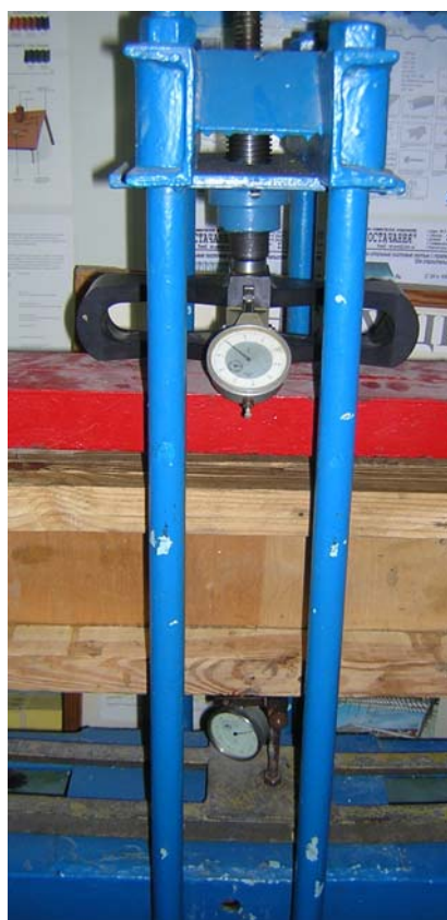
Рис. 6. Клеефанерная балка с плоской стенкой с поясами из деревянных брусков, приклеенных по бокам стенки в испытательном стенде. а – главный вид; б – торец балки на опоре; в – установка приборов на балке
