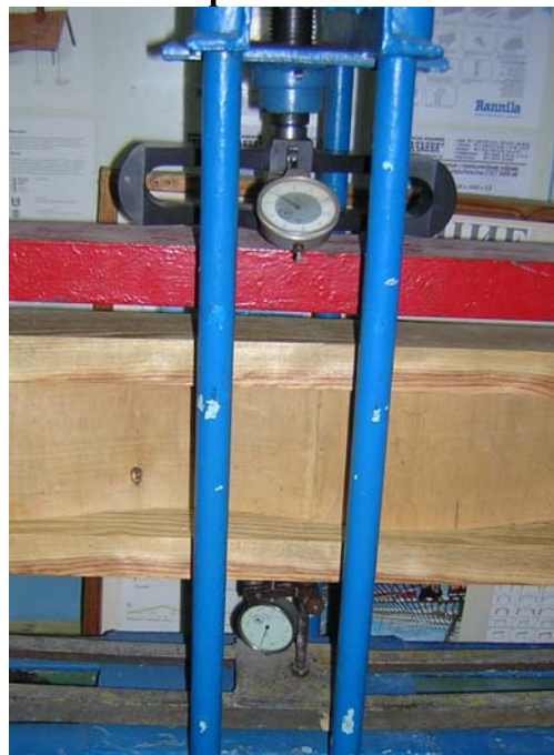
Рис. 8. Клеефанерная балка балка с волнистой стенкой вклеенной в паз осуществленный в полках из цельной древесины в испытательном стенде.
