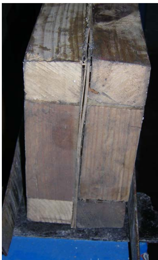
Рис. 6. Клеефанерная балка с плоской стенкой с поясами из деревянных брусков, приклеенных по бокам стенки в испытательном стенде. а – главный вид; б – торец балки на опоре; в – установка приборов на балке
