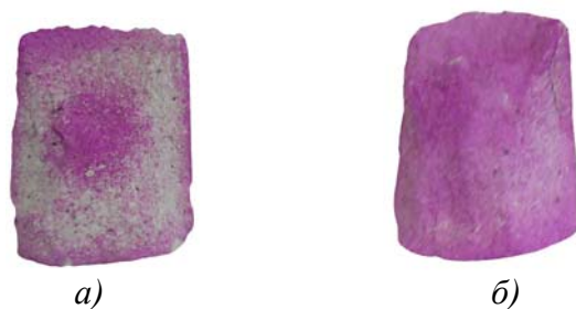
Рис. 3.9. Изменение толщины карбонизированного слоя известковых образцов (влажность 17,5 % мас., удельное давление прессования 7,5 МПа), карбонизированных в течение 21600 с в зависимости от температуры карбонизации, К: а) – 313; б) – 338
