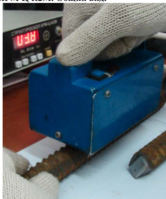
Рис. 6.3.3. Исследования арматурных стержней перед заваркой контрольных стыков
