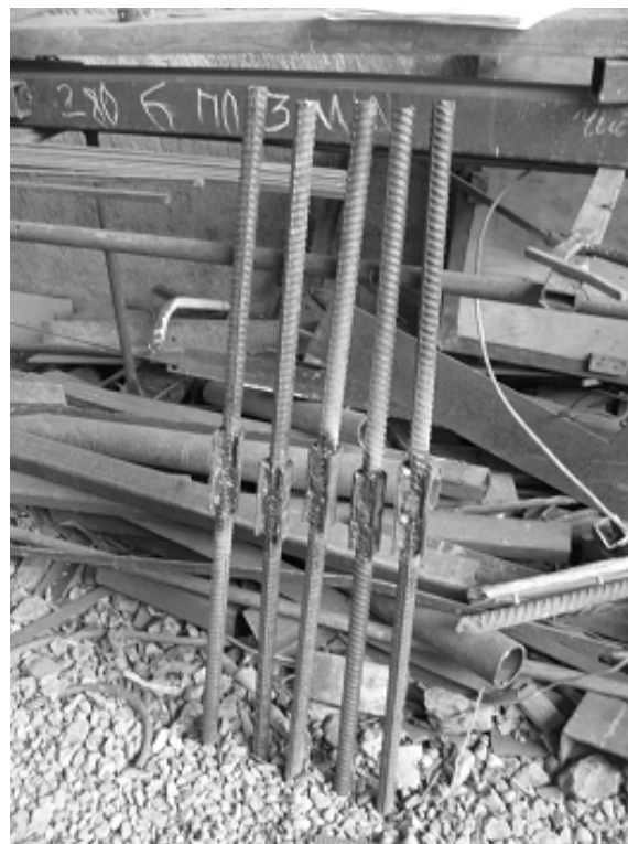
Рис. 6.1.11. Остывание образцов с дефектом
