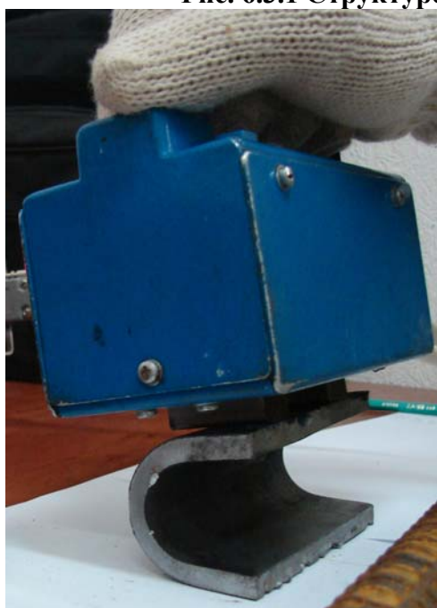
Рис. 6.3.2. Исследования стальной скобы накладке перед заваркой контрольных стыков
