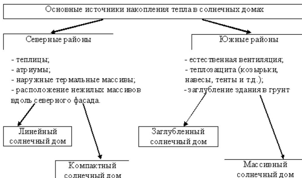
Рис. 2. Источники накопления тепла.
