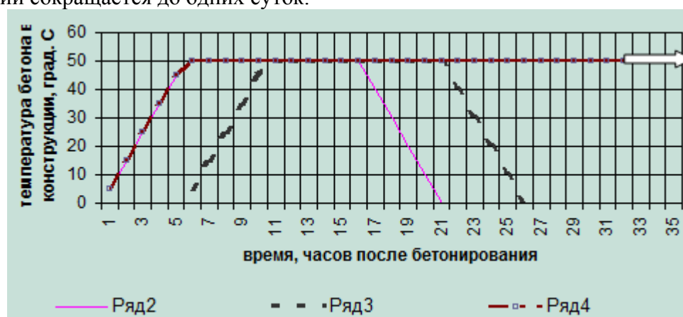
Рис.1 График электропрогрева колонн:
