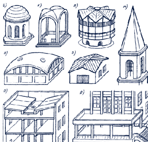
Рис. 2. Крыши: и - куполообразная, к - крестовый свод, л - щипцовая, м - шпалеобразная, н - сферическая оболочка, о - из косых поверхностей, п - с внутренним водостоком, р - плоская эксплуатируемая.
