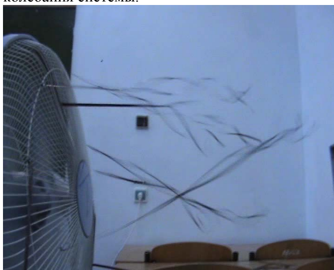
Рис. 9. Автоколебания магнитофонных лент под действием потока ветра.
