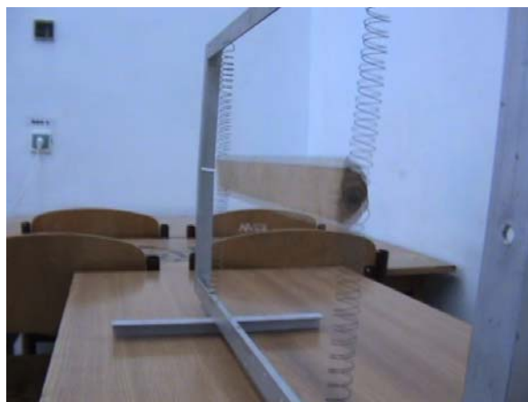
Рис. 8. Автоколебания модели при максимальной скорости потока воздуха.
